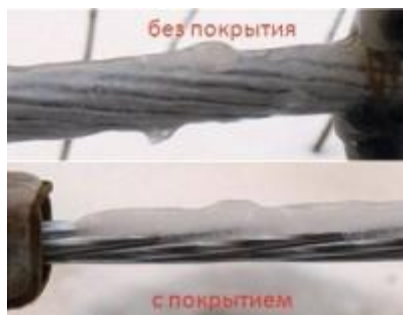
Рисунок 1 – Результаты испытания супергидрофобных покрытий в потоке водного аэрозоля при температуре -5^{\circ}\text{C} и скорости ветра 10\text{ м/с}
